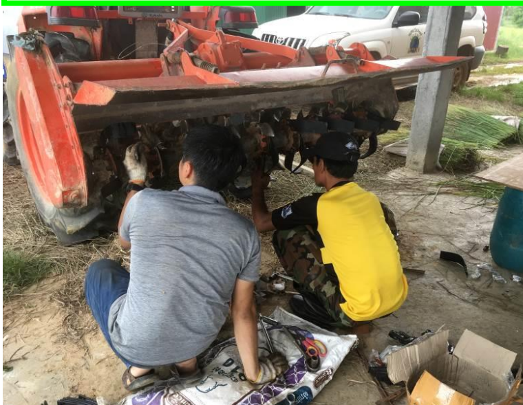
二人がかりでロータリーの刃を交換しています
