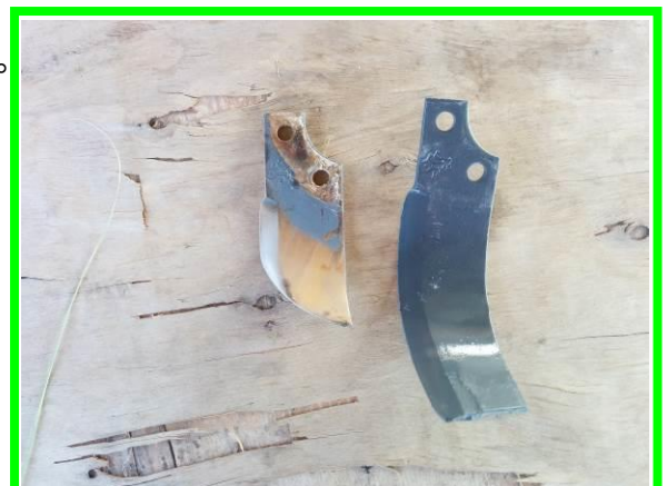
左: 交換前の刃、右: 新しい刃 1 年で半分以上刃がすりへってしまいます。
