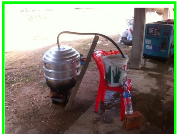
初代蒸留装置。蒸気が漏れ過ぎて全く精油が抽出できませんでした。
