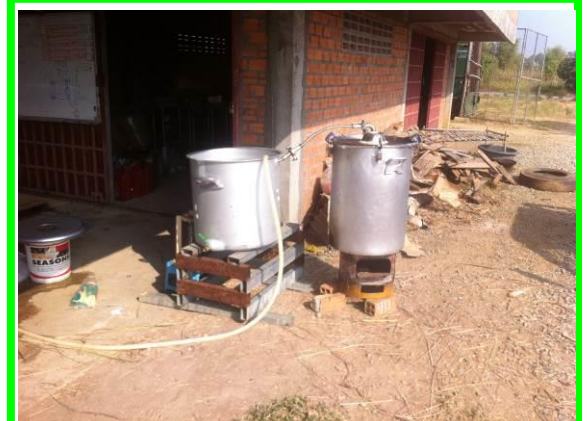
日本から送っていただいた蒸留器具。蒸気が漏れないようにふたと鍋を密閉するのがポイントです。
